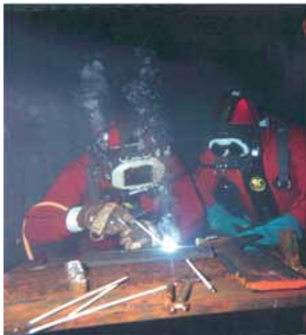
Unterwasserschweißen, Nassschweißen mit Stabelektroden.
