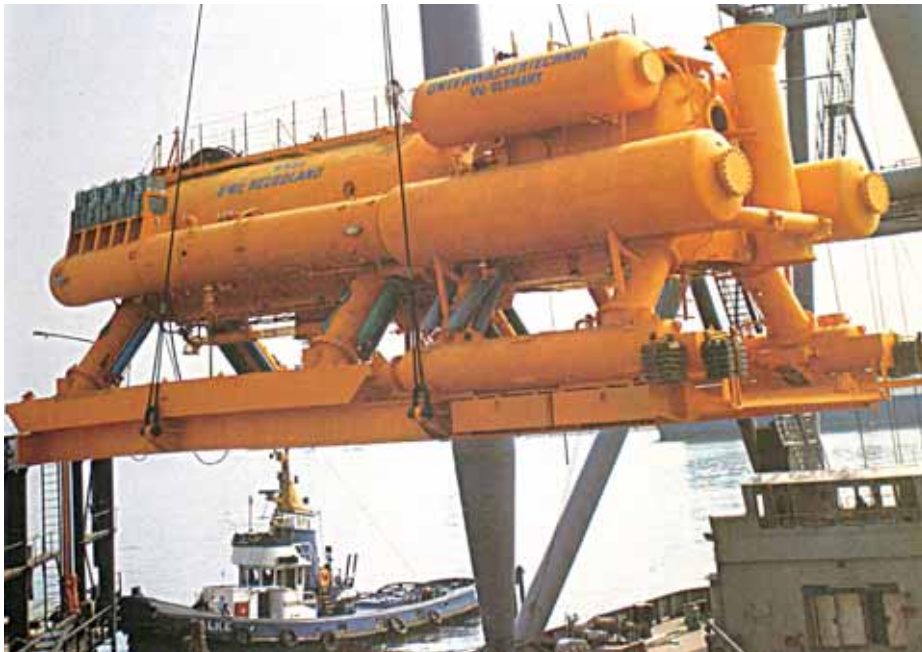
Das Unterwasserlabor HELGOLAND wird mit einem Schwimmkran am Einsatzort zu Wasser gelassen.
