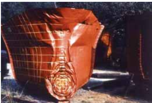
oben: Vorbereitung von Modellkollisionsversuchen im Maßstab 1:12, hier mit dem Vorschiff eines 200.000 tdw-Tankers. unten: Das zerstörte Vorschiff nach Kollision mit einem Schiffsseitenteil mit Kollisionsschutzkonstruktion.
