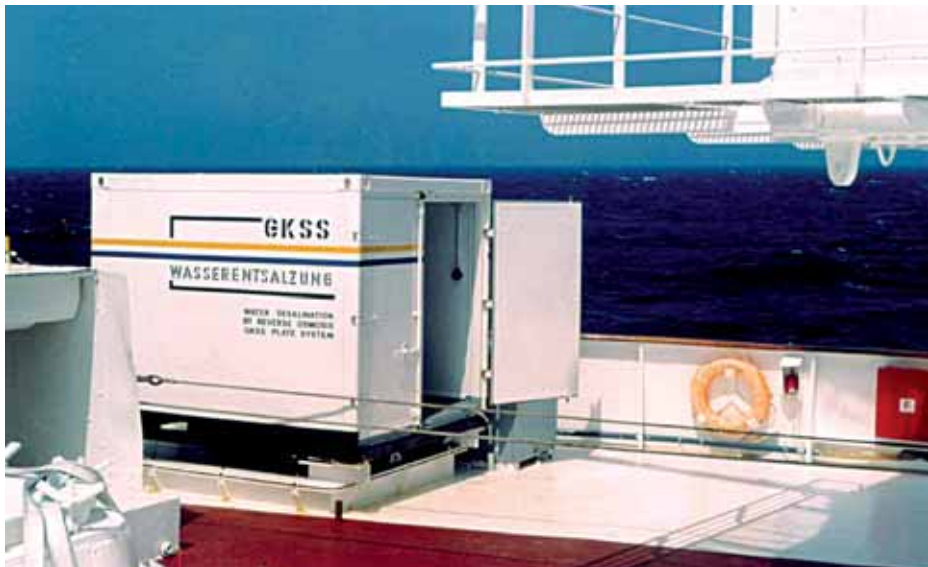
Wasserentsalzungsanlage an Bord der NS OTTO HAHN.
