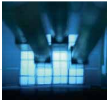
Tscherenkow-Strahlung des FRG-1; Kompaktkern mit 12 Brennelementen.
