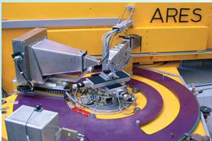
Ansicht des Instruments ARES zur Analyse von Resteigenspannungen.
