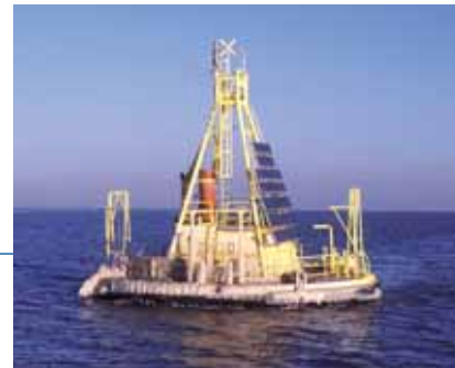
oben: MEDUSA, ein Messinstrument zur Bestimmung von Methan im Meerwasser. rechts: Messsonde META-1.
